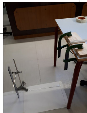
come fissare il profilato all'asta di sostegno; l'estremità dei bastoncini di legno segna il punto di partenza della pallina
