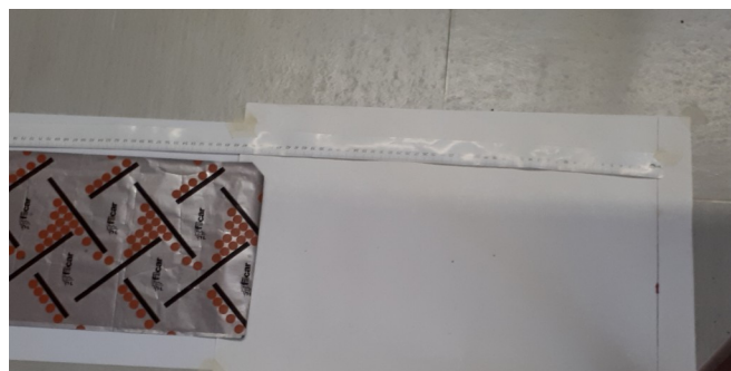
la pallina dovrà cadere sulla carta carbone e lasciare traccia sul sottostante foglio di carta
